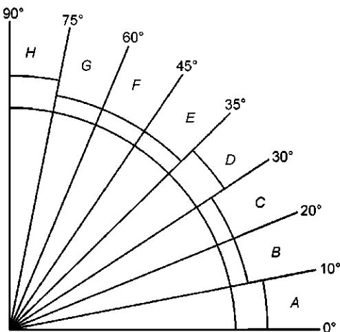
A — пандус рекомендуемый; B — пандус с повышенным сопротивлением скольжению; C — лестница с углом наклона от 20° до 30°; D — лестница с углом наклона от 30° до 38°, рекомендуемая; E — лестница с углом наклона от 38° до 45°; F — лестница с углом наклона от 45° до 60°, рекомендуемая; G — лестница с углом наклона от 60° до 75°; H — лестницы кругонаклонные и вертикальные рекомендуемые
