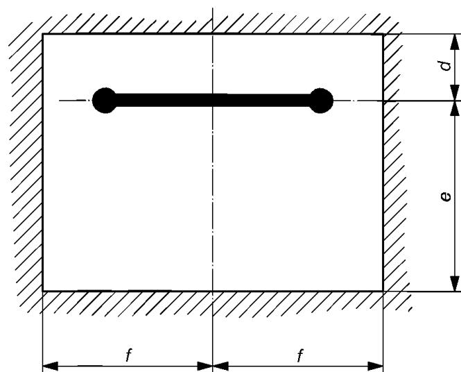
*d* — расстояние между центральной линией ступени и вертикальной поверхностью; *e* — расстояние между лестницей и препятствием сзади для человека, взирающегося по лестнице; *f* — расстояние между осью лестницы и боковым препятствием
