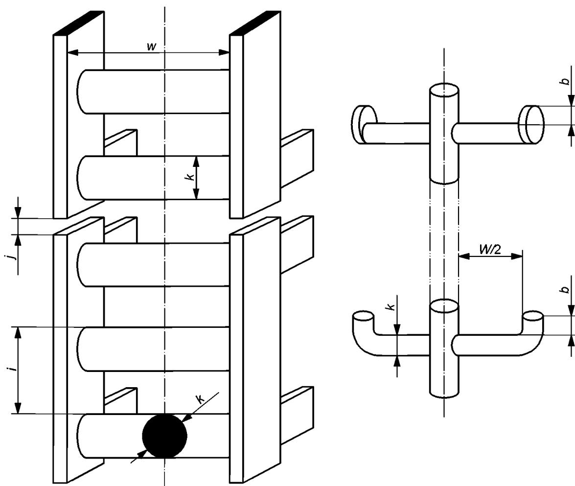
*b* — размер выступа конца ступени; *j* — зазор между отдельными элементами тетивы лестницы;
