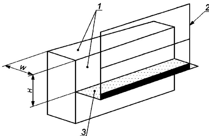
1 — непрерывная поверхность; 2 — перила; 3 — проход;  $H$  — высота непрерывной поверхности;
