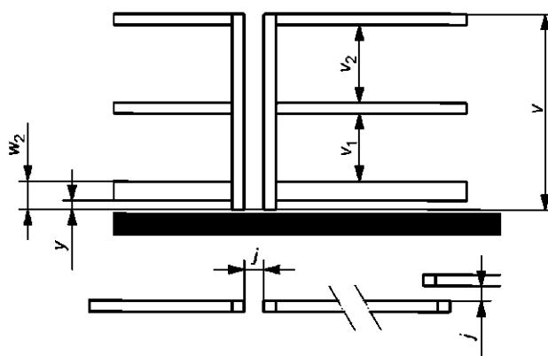
*j* — допустимый разрыв между отдельными секциями перил/поручней; *v* — расстояние между настилом/тетивой лестницы и перилами/поручнем; *v<sub>1</sub>* — зазор между верхом отбортовки и низом ограждения для коленей; *v<sub>2</sub>* — зазор между верхом и низом поручня перил; *w<sub>2</sub>* — расстояние между полом и верхней частью отбортовки; *u* — зазор между полом и нижним краем отбортовки
